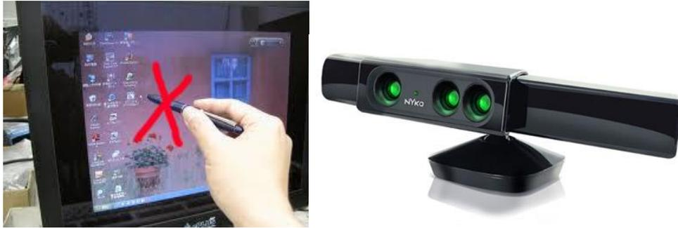
我們的是想要利用 Kinect 來達成遠距離的螢幕觸控，就算是一台只有普通螢幕的電腦，結合 Kinect 的深度以及彩度影像後，我們也可以把它變成貌似擁有觸控螢幕的電腦！
