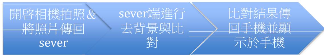
先開啟相機的功能，進行手相拍攝，將拍攝後的手相利用 wifi 傳回 sever 端，開啓程式進行去背景，去背景後的圖片，送進 matlab 進行比對，分別比對三類型的圖片，最後選出相關係數最高的，最後由 sever 端經 wifi 傳回給H T C desire，顯示手相內容與使用動畫將該比對出最明顯的地方呈現出來，輔以文字說明，讓整個螢幕生動。此外還有可以將兩個人的首相求相關係數，以此表示兩人的相關性。
